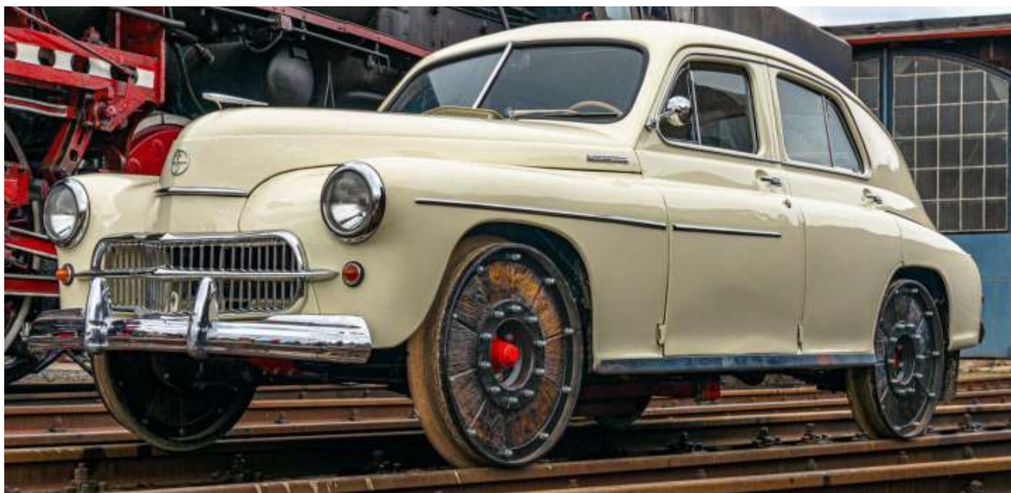
Drezyna kolejowa Warszawa M20 po odbudowie
